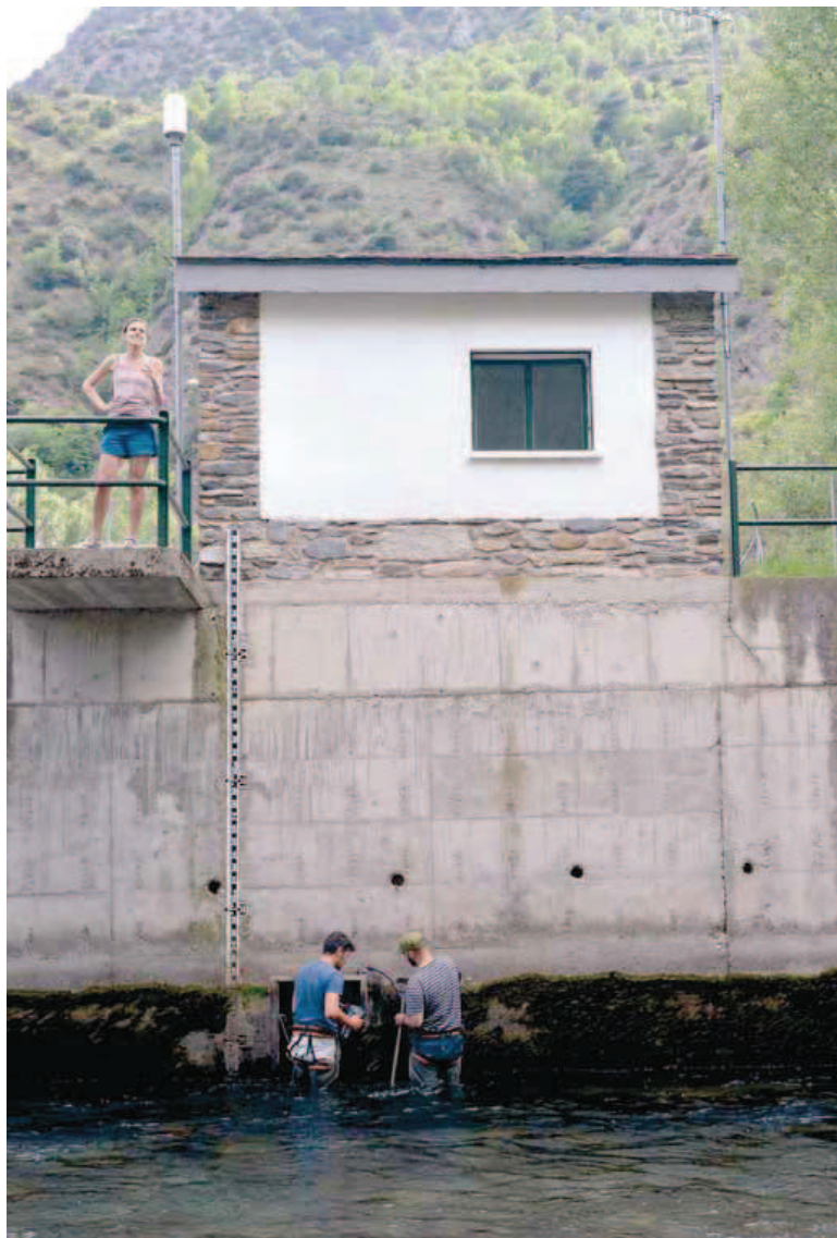
Tècnics del grup investigador instal·lant sensors al riu ■ MARTA LLUVICH / ACN
